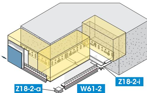
Élément d'angle Z18-2-i/-a ici pour système de support de départ SOLI-TEX-UNO W61-2
