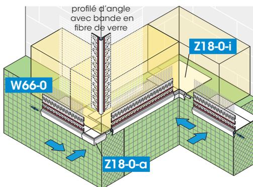
Élément d'angle Z18-0-i/-a ici pour profilé d'arête pour isolation du socle SOKA-TEX-UNO W66-0
