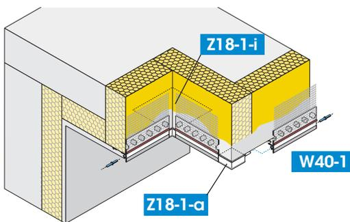
Élément d'angle Z18-1-i/-a ici pour profilé de finition DROP-TEX-UNO W40-1
