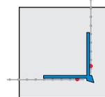
■ Profilé d'angle avec bandes en fibre de verre APU TOP-TEX avec arête de raclage
