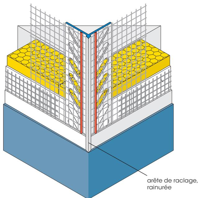
■ Le profilé d'angle avec bandes en fibre de verre APU TOP-TEX peut être utilisé pour des enduits fins et des enduits en couche mince.
