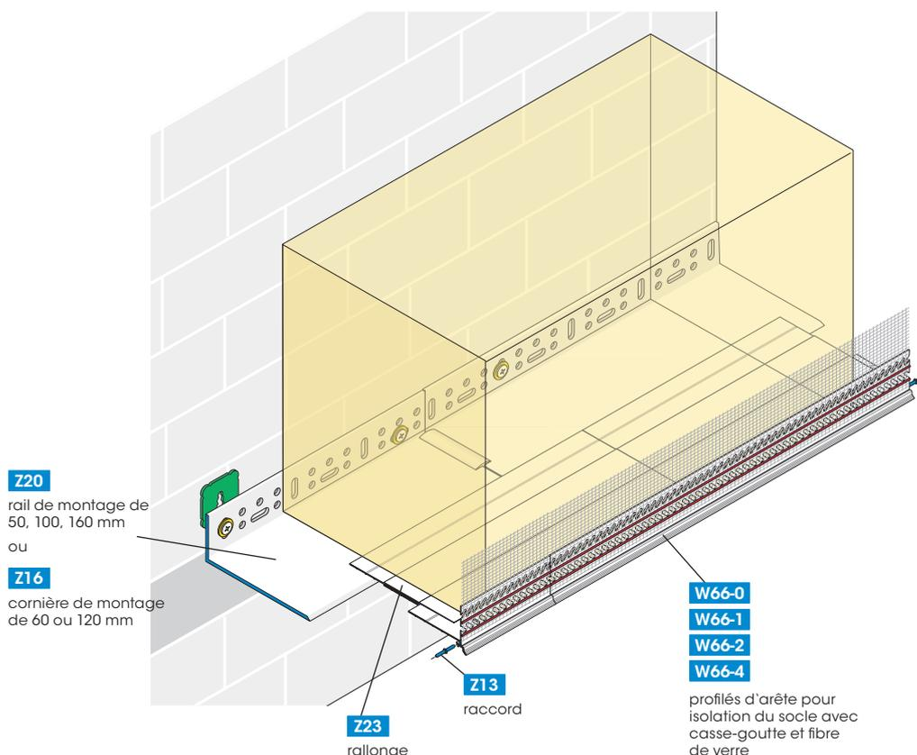
La rallonge en plastique APU Z23 étend la portée des profilés d'arête pour isolation du socle APU SOKA-TEX W66 de 30 à 50 mm. Ainsi, il est possible d'obtenir des épaisseurs d'isolation jusqu'à 300 mm, en combinant le profilé d'arête pour isolation du socle, deux rallonges et le support de départ Z20-160 mm.
