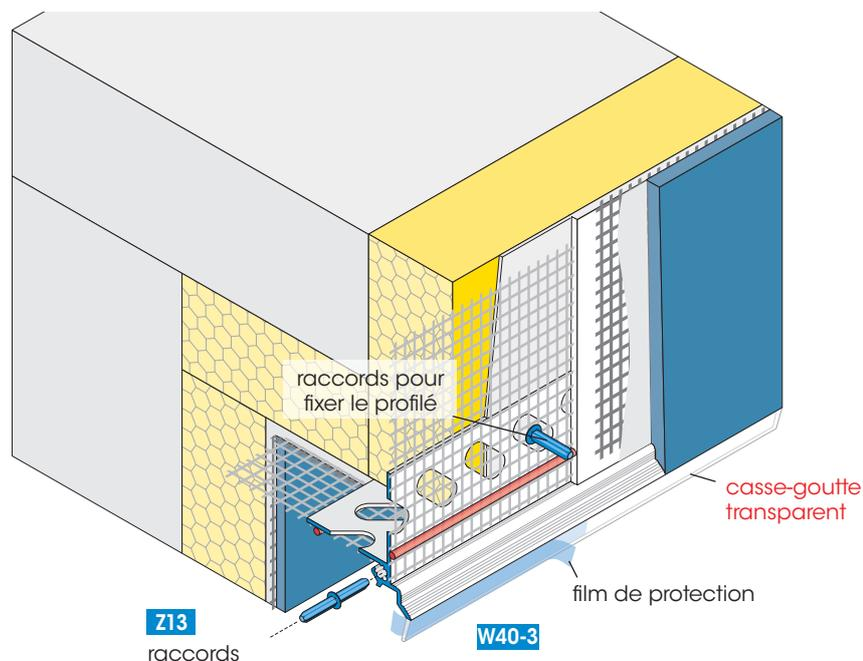
■ Les finitions d'enduit dans les systèmes d'isolation thermique par l'extérieur exigent une solution sûre permettant de diriger et repousser l'eau vers le bas.
